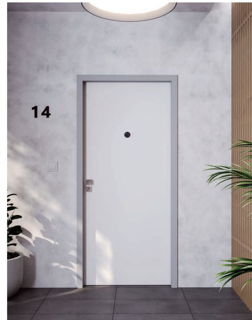
Sicht vom Korridor: Modell ELEGANT 10 - HPL Antifinger Premium weiß W1000, Metallzarge SAP 865 - RAL 7035, Brandschutz 45 min, Sicherheitsklasse RC3, Schallschutz 37 dB und Klimaklasse III, Sicherheitsbeschlag M9, Digitaltürspion Eques S1 Pro
