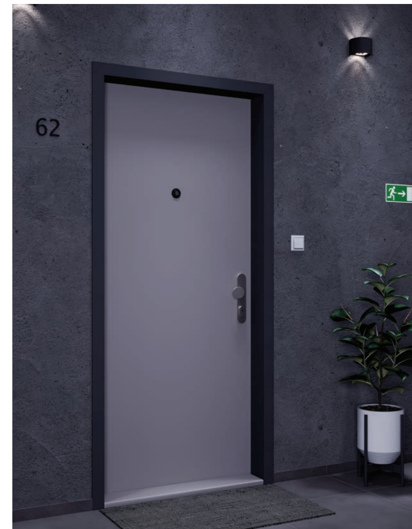
Sicht vom Korridor: ELEGANT 10 - CPL grau U788, Metallzarge SAP 864 - RAL 7016, Brandschutz 30 min, Sicherheitsklasse RC2, Schallschutz 32 dB und Klimaklasse II, Sicherheitsbeschlag 13, Spion
