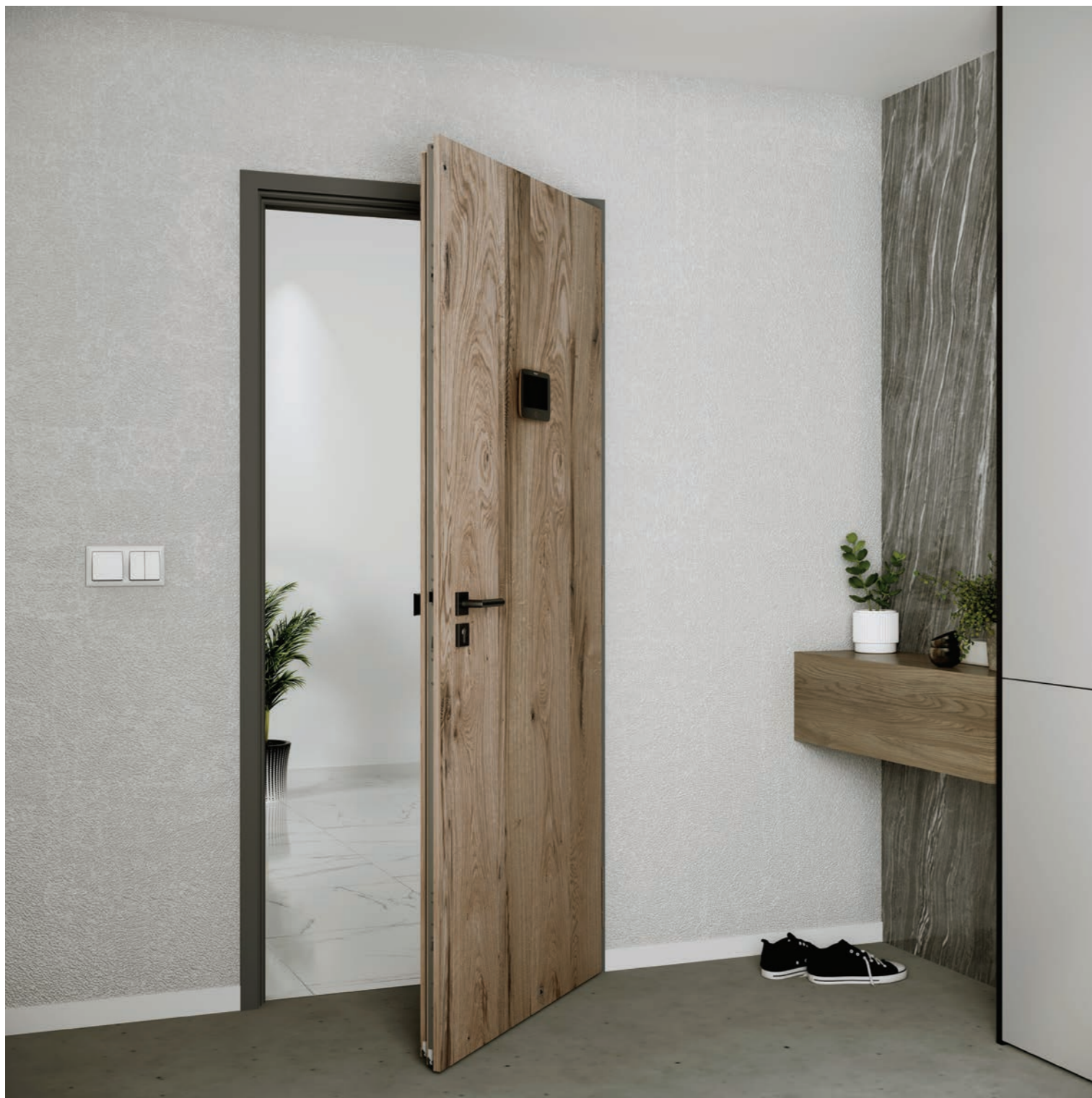
Sicht von der Wohnung: Modell ELEGANT 10 - Furnier Risseiche, Öl Super White, Zarge SAP 871 - RAL 7024, Brandschutz 30 min, Sicherheitsklasse RC3, Schallschutz 43 dB und Klimaklasse III, Sicherheitsbeschlag M9, Digitaltürspion Eques S1 Pro
