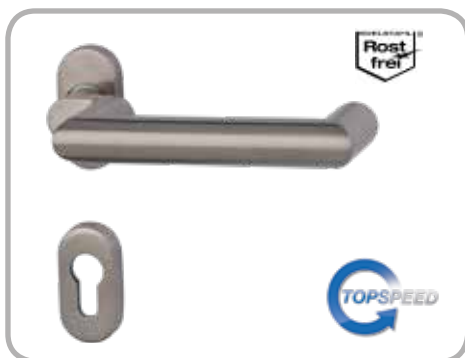
Hanna SP - R , TOP SPEED GK 4 (OBJEKT) Edelstahl-sat., Halbgarnitur, Metallunterkonstruktion, mit Hochhaltefeder, fest/drehbar gelagert, Rosette HxB 74x34 mm, Drückerlänge 160 mm, Drücker Ø 22 mm
