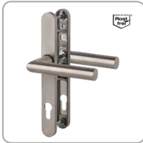
Schutzbeschlag Bremen Schmalrahmenschutzbeschlag PZ 92 mm, Metallunterkonstruktion, fest/drehbar gelagert, für Türstärke 80-87 mm, Schildbreite 30 mm
