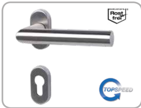
Galina II - R , TOP SPEED GK 4 (OBJEKT) Edelstahl-sat., Halbgarnitur, Metallunterkonstruktion, mit Hochhaltefeder, fest/drehbar gelagert, Rosette HxB 74x34 mm, Drückerlänge 140 mm, Drücker Ø 22 mm
