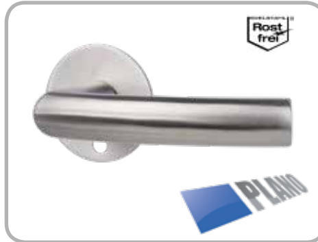
Katy Solo - R, GK 3 Edelstahl-sat., 2 mm flache Rosette, Rosette Ø 60 mm, Drücker oval, Drückerlänge 133 mm, Stützknoppenbohrung Ø 7 - 7,2 mm, Bohrtiefe 12 mm
