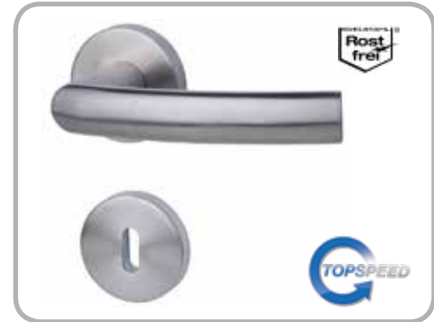
Katy - R, TOP SPEED GK 3 Edelstahl-sat., Metallunterkonstruktion, mit Hochhaltefeder, fest/drehbar gelagert, Rosette Ø 55 mm, Drückerlänge 133 mm
