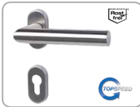
Ronny II - R , TOP SPEED GK 4 (OBJEKT) Edelstahl-sat., Halbgarnitur, Metallunterkonstruktion, mit Hochhaltefeder, fest/drehbar gelagert, Rosette HxB 74x34 mm, Drückerlänge 135 mm
