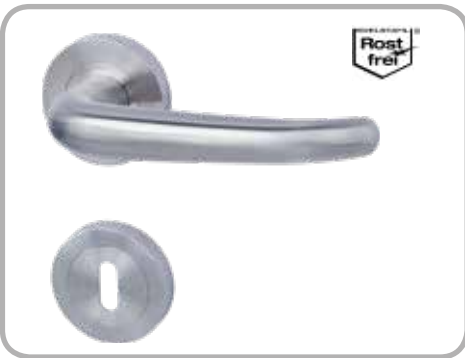
New Orleans - R Edelstahl-sat., Metallunterkonstruktion, mit Hochhaltefeder, fest/drehbar gelagert, Schraubrossette Ø 52 mm
