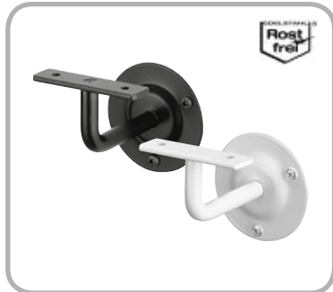
Handlaufstütze Metall beschichtet, Wandabstand 80 mm, Rosette Ø 80 mm
