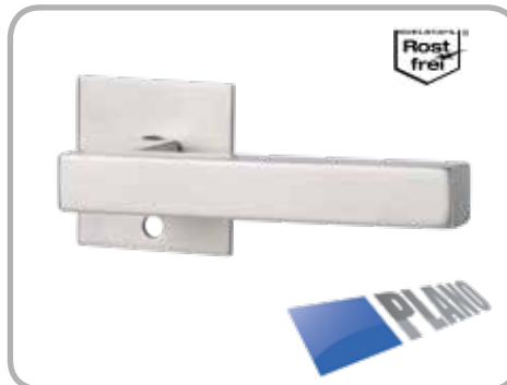
Galina Square Solo - R, GK 3 Edelstahl-sat., 2 mm flache Rosette, Rosette 60x60 mm, Drücker 20x20 mm, Drückerlänge 138 mm, Stützknoppenbohrung Ø 7 - 7,2 mm, Bohrtiefe 12 mm
