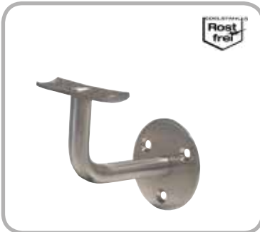
Handlaufstütze Edelstahl Korn 240 matt, 3-Punkt Befestigung, Wandabstand 75 mm, Rosette Ø 60 mm
