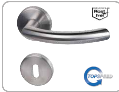
Jill - R, TOP SPEED GK 4 (OBJEKT) Edelstahl-sat., Metallunterkonstruktion, mit Hochhaltefeder, fest/drehbar gelagert, Rosette Ø 55 mm, Drückerlänge 134 mm
