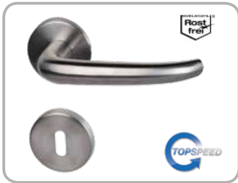
Madrid - R, TOP SPEED GK 3 Edelstahl-sat., Metallunterkonstruktion, mit Hochhaltefeder, fest/drehbar gelagert, Rosette Ø 55 mm, Drücker Ø 20 mm, Drückerlänge 135 mm
