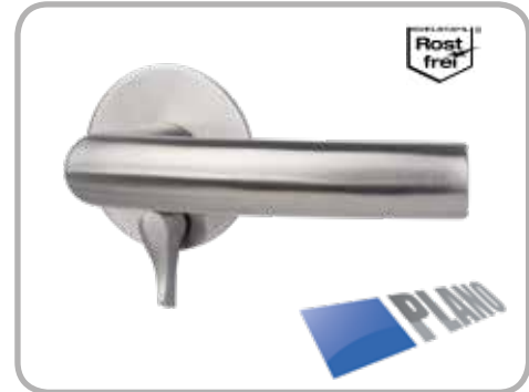
Katy Solo - R, GK 3 Edelstahl-sat., 2 mm flache Rosette, Rosette Ø 60 mm, Drücker oval, Drückerlänge 133 mm, Stützknoppenbohrung Ø 7 - 7,2 mm, Bohrtiefe 12 mm
