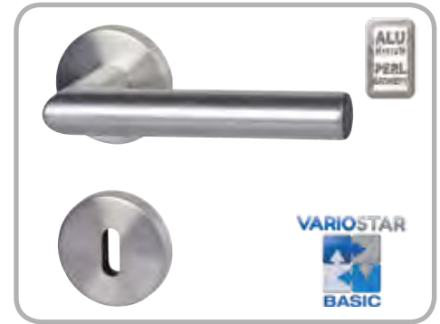
Ronny - R, BASIC GK 3 Aluminium F1 Perl-sat., Nylonunterkonstruktion, mit Hochhaltefeder, Rosette Ø 55 mm, Drückerlänge 130 mm
