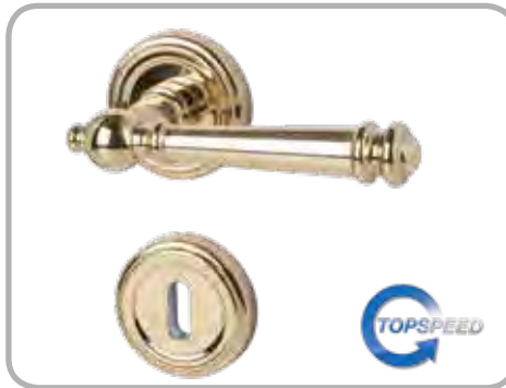
Mount Everest - R, TOP SPEED GK 3 Messing poliert, Metallunterkonstruktion mit Hochhaltefeder, fest/drehbar gelagert, Rosette Ø 55 mm, Drückerlänge 130 mm
