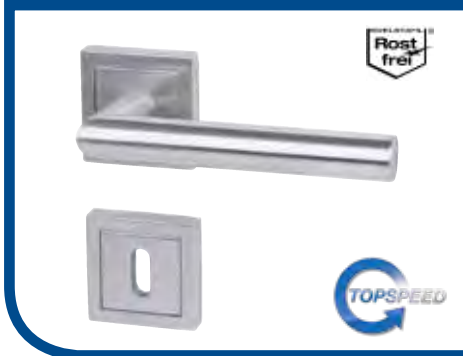
Ronny Square - R, TOP SPEED GK 3 Edelstahl-sat., Metallunterkonstruktion, mit Hochhaltefeder, fest/drehbar gelagert, Rosette 54x54 mm, Drückerlänge 135 mm
