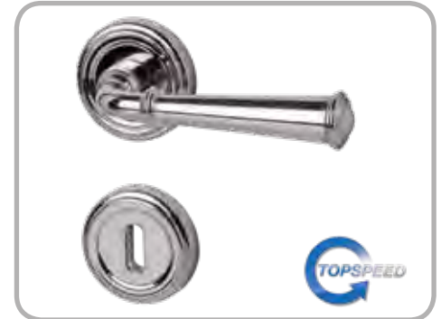
Nebraska - R, TOP SPEED GK 3 Edelstahlfärbig-pol., Metallunterkonstruktion mit Hochhaltefeder, fest/drehbar gelagert, Rosette Ø 55 mm, Drückerlänge 130 mm
