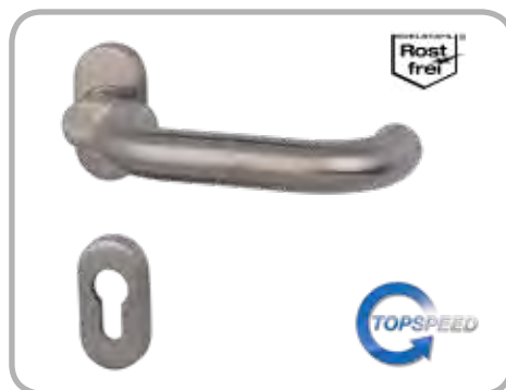
Paula III SP - R , TOP SPEED GK 4 (OBJEKT) Edelstahl-sat., Halbgarnitur, Metallunterkonstruktion, mit Hochhaltefeder, fest/drehbar gelagert, Rosette HxB 74x34 mm, Drückerlänge 160 mm, Drücker Ø 22 mm
