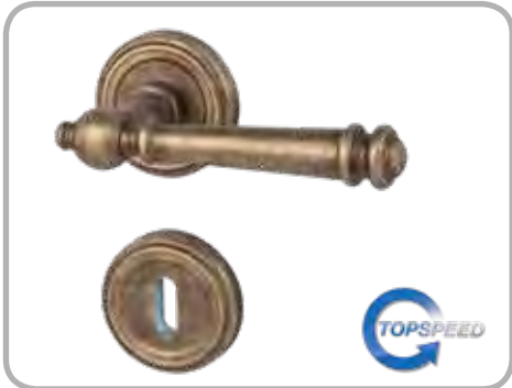
Mount Everest - R, TOP SPEED GK 3 Antik Bronze, Metallunterkonstruktion mit Hochhaltefeder, fest/drehbar gelagert, Rosette Ø 55 mm, Drückerlänge 130 mm
