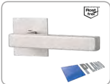
Galina Square Solo - R, GK 3 Edelstahl-sat., 2 mm flache Rosette, Rosette 60x60 mm, Drücker 20x20 mm, Drückerlänge 138 mm, Stützknoppenbohrung Ø 7 - 7,2 mm, Bohrtiefe 12 mm
