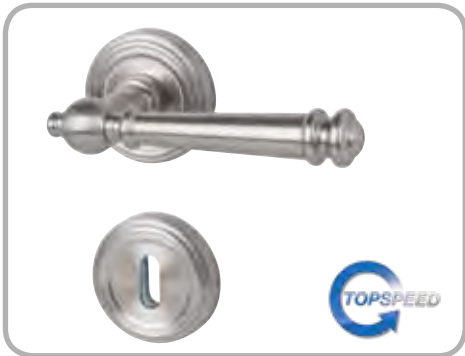
Mount Everest - R, TOP SPEED GK 3 Edelstahlfärbig-sat., Metallunterkonstruktion mit Hochhaltefeder, fest/drehbar gelagert, Rosette Ø 55 mm, Drückerlänge 130 mm
