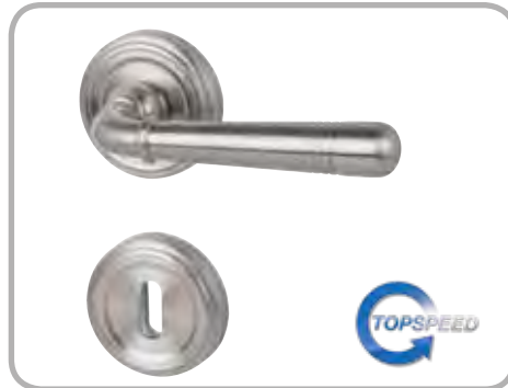
Scarlet - R, TOP SPEED GK 3 Edelstahlfärbig-sat., Metallunterkonstruktion, mit Hochhaltefeder, fest/drehbar gelagert, Rosette Ø 55 mm, Drückerlänge 125 mm
