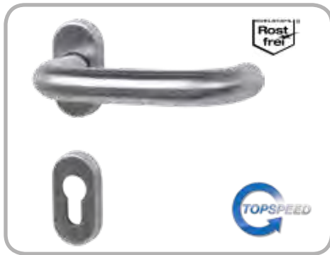
Paula III - R , TOP SPEED GK 4 (OBJEKT) Edelstahl-sat., Halbgarnitur, Metallunterkonstruktion, mit Hochhaltefeder, fest/drehbar gelagert, Rosette HxB 74x34 mm, Drückerlänge 152 mm, Drücker Ø 22 mm
