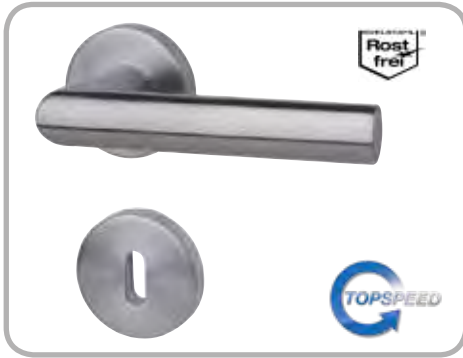
Erika - R, TOP SPEED GK 3 Edelstahl-sat., Metallunterkonstruktion, mit Hochhaltefeder, fest/drehbar gelagert, Rosette Ø 55 mm, Drückerlänge 135 mm
