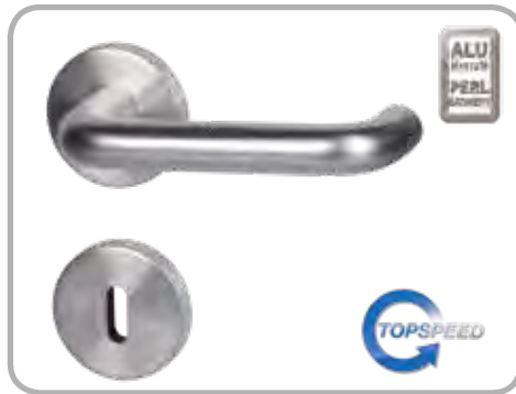
Paula - R, TOP SPEED GK 3 Aluminium F1 Perl-sat., Metallunterkonstruktion, mit Hochhaltefeder, fest/drehbar gelagert, Rosette Ø 55 mm, Drückerlänge 131 mm
