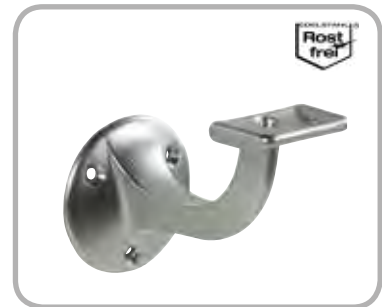
Handlaufstütze Aluminium F1, Wandabstand 75 mm, Rosette Ø 56 mm, 3-Punkt-Befestigung
