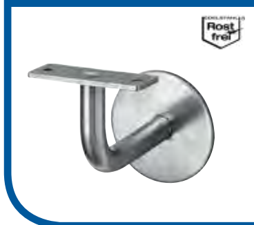
Handlaufstütze Edelstahl Korn 240, Wandabstand 75 mm, Rosette Ø 60 mm, unsichtbare Befestigung
