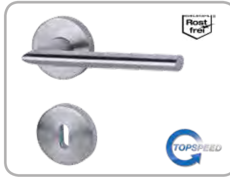
Zoe - R, TOP SPEED GK 3 Edelstahl-sat., Metallunterkonstruktion, mit Hochhaltefeder, fest/drehbar gelagert, Rosette Ø 55 mm, Drückerlänge 130 mm
