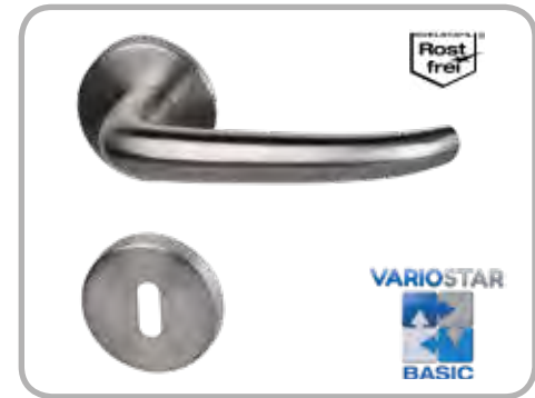
Madrid - R, BASIC GK 3 Edelstahl-sat., Nylonunterkonstruktion, mit Hochhaltefeder, Rosette Ø 55 mm, Drücker Ø 20 mm, Drückerlänge 135 mm
