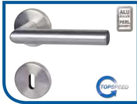
Ronny - R, TOP SPEED GK 3 Aluminium F1 Perl-sat., Metallunterkonstruktion, mit Hochhaltefeder, fest/drehbar gelagert, Rosette Ø 55 mm, Drückerlänge 130 mm
