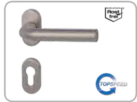
Patrik III - R , TOP SPEED GK 4 (OBJEKT) Edelstahl-sat., Halbgarnitur, Metallunterkonstruktion, mit Hochhaltefeder, fest/drehbar gelagert, Rosette HxB 74x34 mm, Drückerlänge 140 mm, Drücker Ø 22 mm
